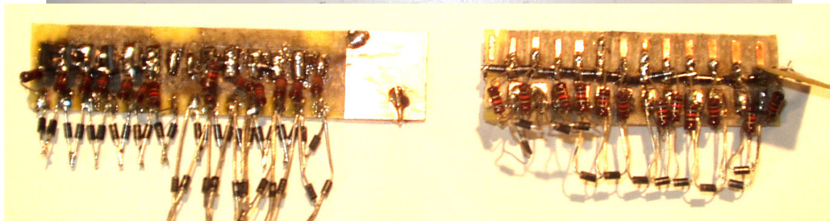
Abbildung 8: zweite und dritte 6kV-Stufen: oben: zweite Stufe mit 6 COTS-Transistoren, dritte Stufe mit 5 COTS-Transistoren und einer Diode. Unten Varianten mit reinen Diodenstufen.
