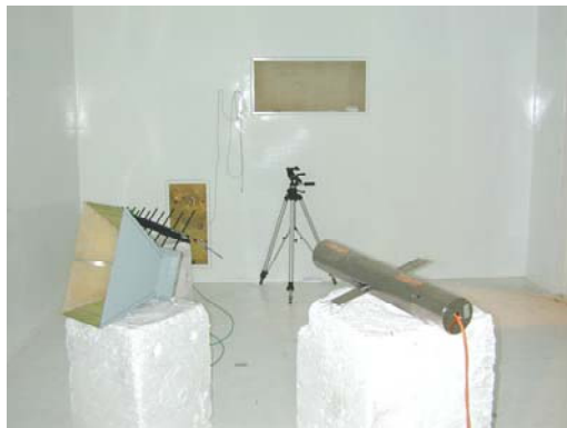
Abb.4: Messaufbau und notwendige CW-Feldstärke bis zum Erreichen eines Störschwellwertes mit und ohne medium-Schirmung als Funktion der Trägerfrequenz
