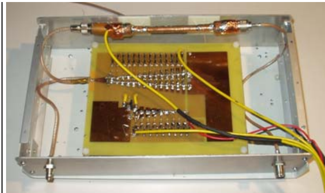
Abb.9: 3-stufiger UWB-Pulsar der FH-Gelsenkirchen mit COTS-Dioden im transienten Avalanche Betrieb und koaxialer Endstufe
