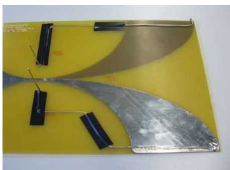
Abb.6: Links: 5kV-Vivaldiantenne der FH-Gelsenkirchen und rechts: abgestrahlter DS-Puls mit UWB-Anteil.
